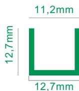
Perfil de alumínio inferior tipo baguete 11,2x12,7mm para portas.
