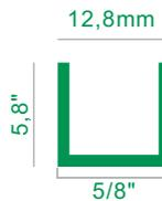
Perfil de alumínio inferior tipo baguete 12,8x5,8" para portas.
